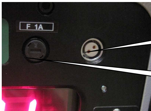
Abbildung Ladebuchse der Waage (Frontseite der Waage)
