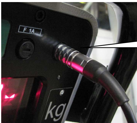
Abbildung Ladebuchse mit Ladestecker
